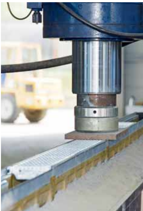
Dichtheidstesten na lange duur simulatie
