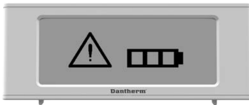
Fig. 6 : Alerte de pile faible Remplacez la pile de votre télécommande HRC4.
