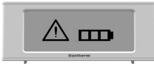
Abb. 6: Alarm bei niedriger Batteriespannung Wechseln Sie die Batterie in Ihrer HRC4-Fernbedienung aus.
