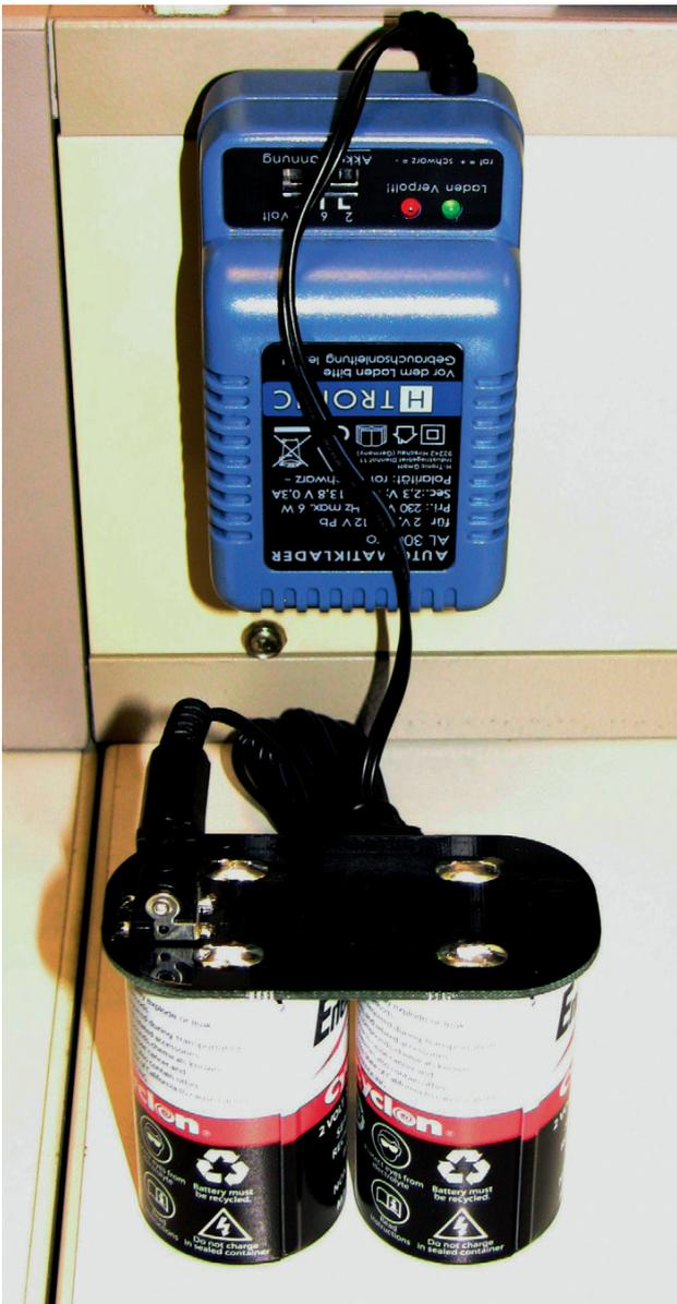
Der TRAPMASTER wird inklusive eines Spezial-Akkus ausgeliefert. Dieser Akku ist für einen sehr großen Temperaturbereich (bis hinab zu  $-40^{\circ}\text{C}$ ) ausgelegt, um die zuverlässige Fallenüberwachung auch bei länger andauernden Minustemperaturen sicherzustellen.
