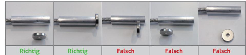
Befindet sich der Magnet nahe genug beim Näherungsschalter (berührungslos oder angeheftet), so schließt dieser. Bewegt sich der Magnet beim Schließen der Klappen vom Näherungsschalter weg, so löst der Melder Alarm aus.
