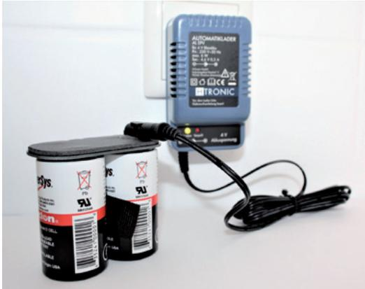
Der TRAPMASTER wird inklusive eines Spezial-Akkus ausgeliefert. Dieser Akku ist für einen sehr großen Temperaturbereich (bis hinab zu  $-40^{\circ}\text{C}$ ) ausgelegt, um die zuverlässige Fallenüberwachung auch bei länger andauernden Minustemperaturen sicherzustellen.
