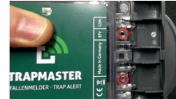
Um Unbefugten das Öffnen des Melders zu erschweren, kann der Deckel mit 2 Schrauben (3 x 20 mm) gesichert werden.
