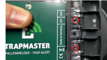
Um Unbefugten das Öffnen des Melders zu erschweren, kann der Deckel mit 2 Schrauben (3 x 20 mm) gesichert werden.
