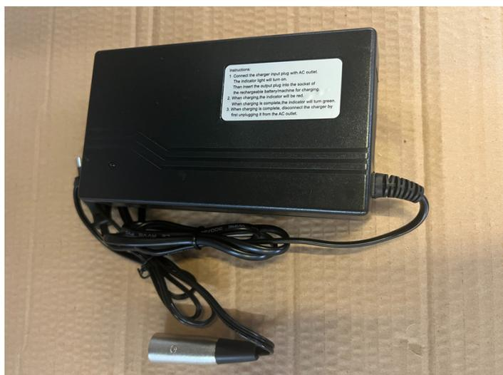
**22. Achten Sie auf das Ladegerät das es keine Schäden hat. bei einem defekten Ladegerät können die Batterien Überladen werden. Ladezeit ist ca. 12 Stunden**
