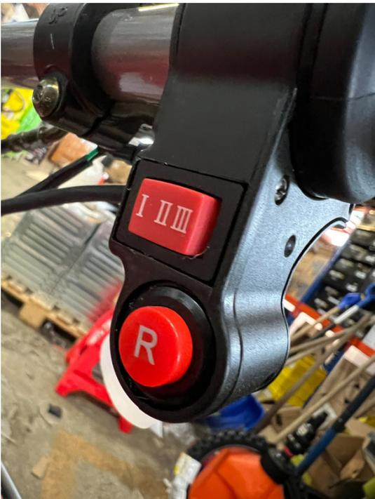
18. Geschwindigkeisstufen Schalter
