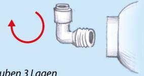
**Tipp:** Wickeln Sie vor dem Einschrauben 3 Lagen Teflonband um das Gewinde. Dadurch ist die Verbindung optimal abgedichtet.
