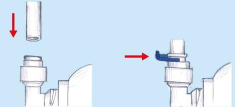
Achten Sie darauf, dass die Schläuche fest bis zum Anschlag in den Schlauchverbindern stecken.
