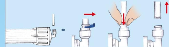
Öffnen Sie das Membranhäuser und entnehmen die Membrane.
