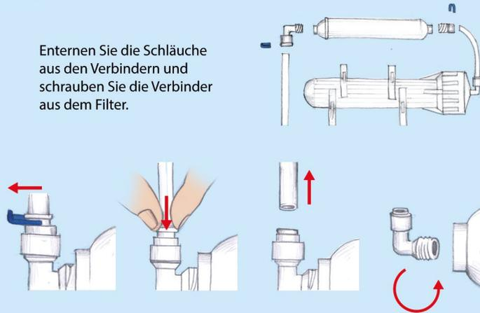
Innenring runter drücken um Schlauch zu lösen
