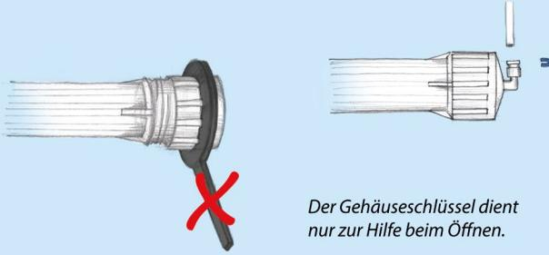
Der Gehäuseschlüssel dient nur zur Hilfe beim Öffnen.
