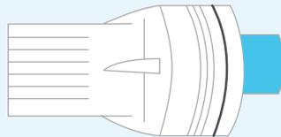
Achten Sie darauf, dass der Dichtungsring (Gehäuse) nicht beschädigt ist und richtig auf dem Gehäuse sitzt.
