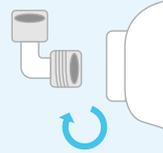
Achten Sie darauf, dass die Schläuche fest bis zum Anschlag in den Schlauchverbindern stecken.
