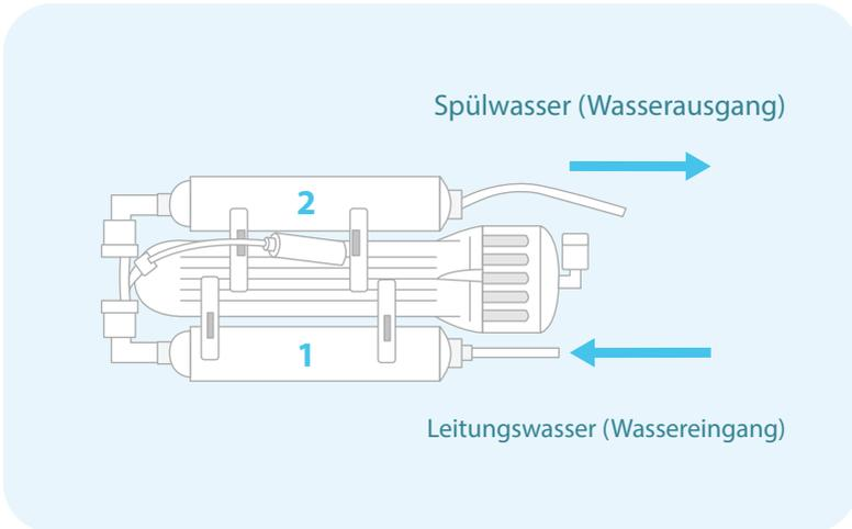
Schließen Sie die Schlauchleitung vom Wasserhahn zum Sedimentfilter (1) an. Zum Aktivkohlefilter (2) schließen Sie die Abwasserleitung an. Spülen Sie nun die Filter ohne Membrane 10-15 min lang bis das Wasser klar ist.
