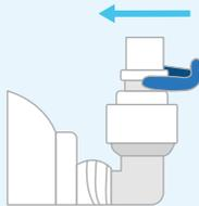
Achten Sie darauf, dass der Schlauch fest bis zum Anschlag in dem Schlauchverbinder steckt.
