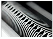
Schneidwellen aus gehärtetem Vollstahl
