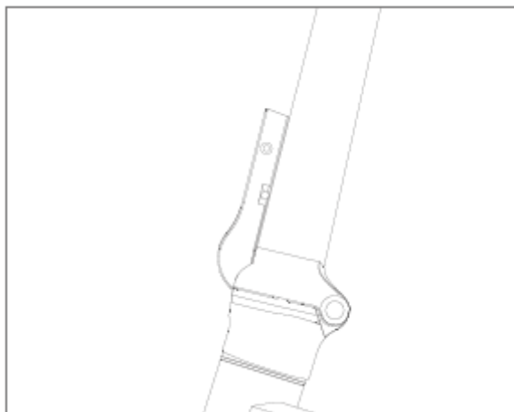
3) Schud de stuurpen om te controleren of de hendel goed vast zit.
