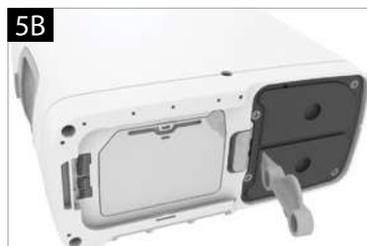
6. A. Maintenez le bouton en position ouverte et sortez les colonnes du dispositif en tirant sur la poignée correspondante.
