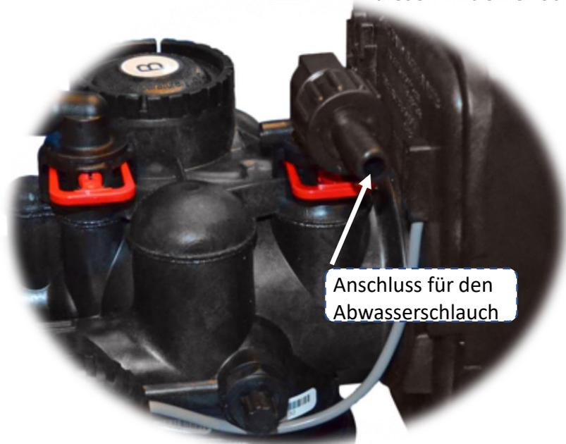
Abwasserseitig wird der Schlauch am Siphon aufgesteckt und muss gegen herausrutschen gesichert werden. Bei der Aufstellung der Anlage bitte darauf achten, dass das Abwasser ungehindert abfließen kann. Ein Gefälle ist vorzusehen, auch wenn die Enthärtungsanlage Abwasser bis 200cm über dem Steuerventil befördern kann. Idealerweise verwenden Sie einen Kanalanschluss mit offenem Auslauf, wie unten abgebildet.
