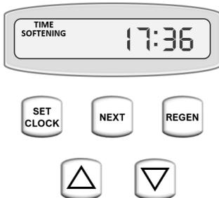
Die Anlage wurde werksseitig mit der Kapazität des Enthärterharzes vorprogrammiert. Die Elektronik benötigt nun kundenseitig weitere Angaben für den korrekten Betrieb. Um diese Daten einzugeben, bitte gleichzeitig die Tasten **NEXT** und **▲** für **2 Sekunden** drücken, um von der Hauptebene (Anzeige Uhrzeit) in den Eingabemodus zu gelangen.
