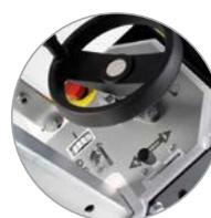
Réglage aisé de la profondeur de coupe et de la vitesse de rotation
