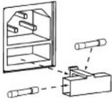
Paso 1: Abra el portafusibles del panel trasero con un destornillador adecuado.
