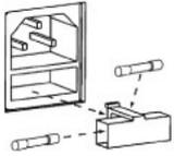
Schritt 1: Öffnen Sie den Sicherungshalter an der Geräterückseite mit einem passenden Schraubendreher.
