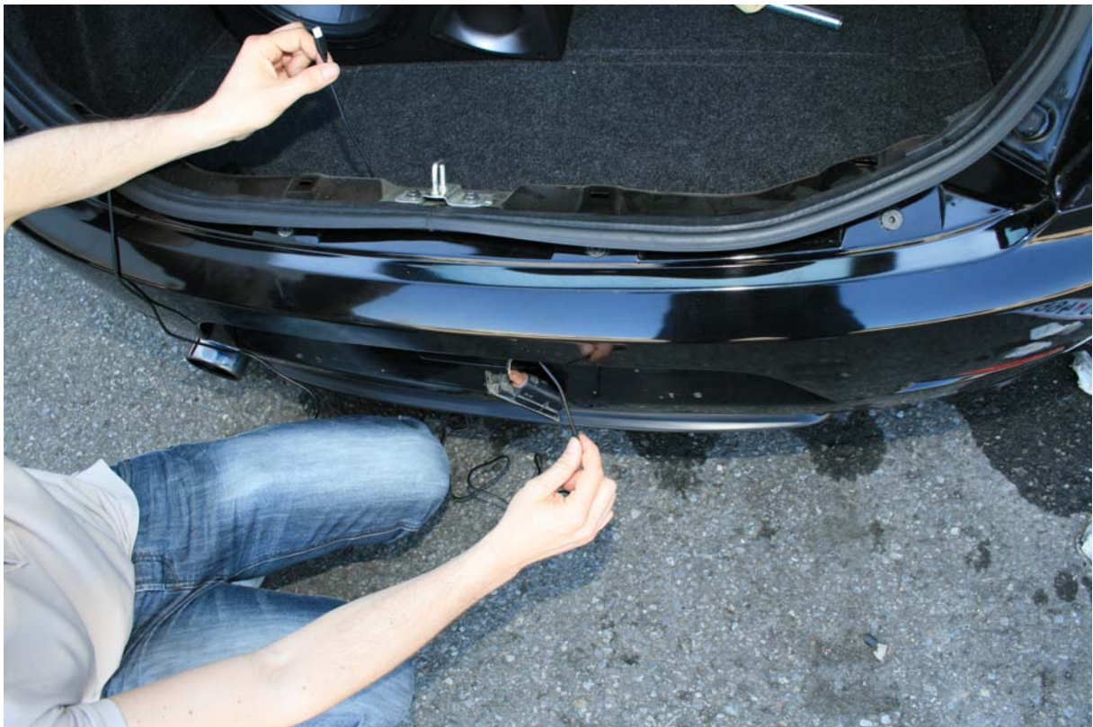
Schritt 3: Das Kabel der Kamera wird ins Fahrzeuginnere geführt.
