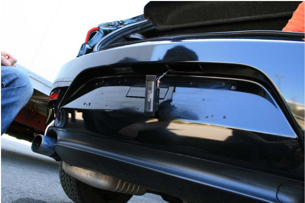
Schritt 3: Das Kabel der Kamera wird ins Fahrzeuginnere geführt.
