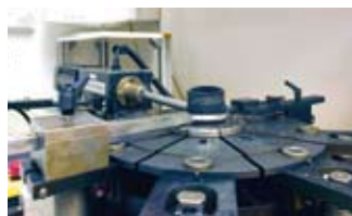
Belastungsverlust-Test in 8 Sektoren
