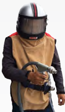
Volgelaatsmasker Straalmasker voorzien van stoffilter.
