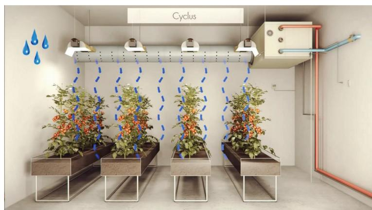
El aire se distribuye uniformemente a través del espacio con las mangueras distribuidoras de aire para que cada planta experimente exactamente las mismas condiciones y puedan recibir el CO<sub>2</sub> y el aire fresco de una forma correcta en toda la sala de cultivo independientemente del lugar donde esté ubicada. Un clima constante, casi perfecto, tiene un gran impacto en el bienestar de sus cultivos y le ayudará a lograr de una manera fiable mayores rendimientos, durante todo el año.
