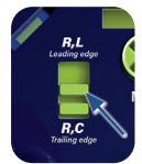
R,L = coupeure de phase ascendante R,C = coupeure de phase descendante
