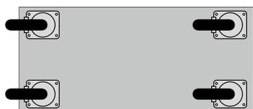
Quatre roulettes pivotantes, si nécessaire, une roulette pivotante avec blocage directionnel peut être utilisée.
