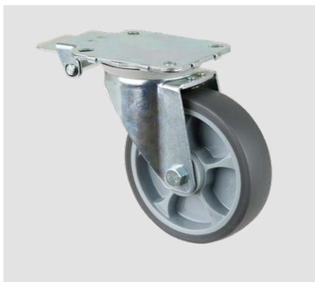
Monture en tôle d'acier · galvanisé-chromé · couronne du pivot à double chemin de billes dans la monture
