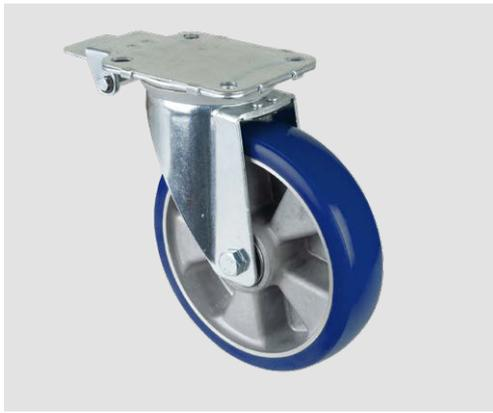
Monture en tôle d'acier · galvanisé-chromé · couronne du pivot à double chemin de billes dans la monture
