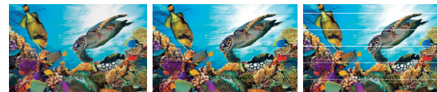
Position incorrecte de dépôt bidirectionnel des gouttelettes Chevauchement / Traces noires (Alimentation papier insuffisante) Écart / Traces blanches (Alimentation papier excessive)
