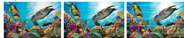
Fehlerhafte Tropfposition bei BIDI-Druck Überlappung/schwarze Streifen (Vorschub zu gering) Lücke/helle Streifen (Vorschub zu hoch)
