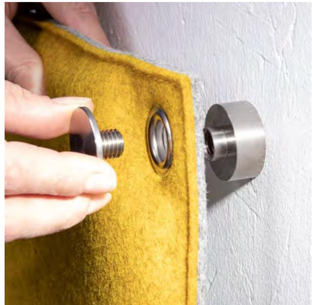
9. Die Deckschraube vom Abstandshalter schrauben (Linksgewinde!). Schraube in den Abstandhalter einstecken und in den Dübel einschrauben.
