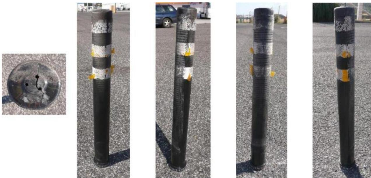
Figura 6 – Desgaste da amostra após 1000 embates.
