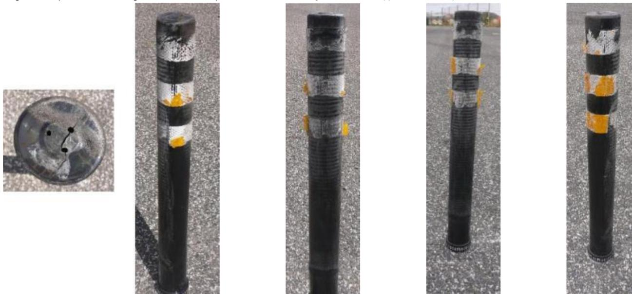
Figura 5 – Desgaste da amostra após 750 embates.
