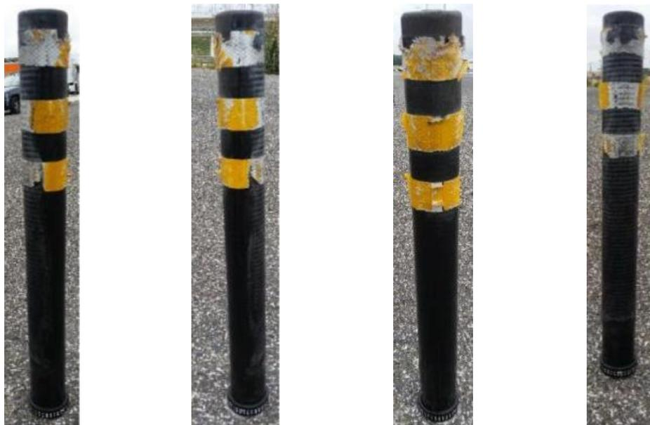
Figura 4 – Desgaste da amostra após 500 embates.
