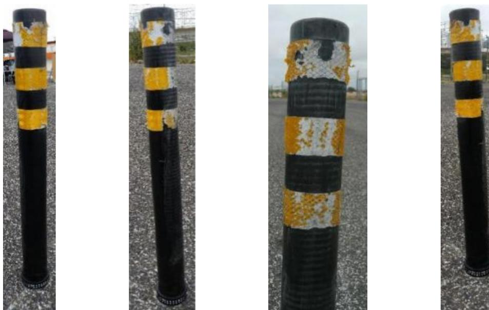
Figura 3 – Desgaste da amostra após 300 embates.
