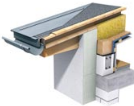
Abb. 1: Belüftete Dachkonstruktion mit Sparren-Volldämmung
