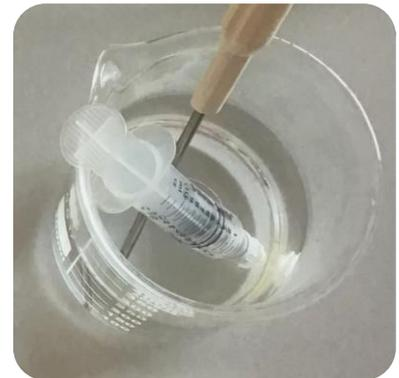
Die beiden 30 mL-Spritzen werden mit Magnesiumband und die zwei 10 mL-Spritzen mit je 3 mL Säure blasenfrei befüllt. Letztere werden mit dem Rückschlagventil verschlossen für ca. 1 Minute in Eiswasser bzw. in anfänglich ca. 55 °C warmes Wasser gelegt. Höhere Temperaturen sind wegen der Verbrühungsgefahr nicht sinnvoll.
